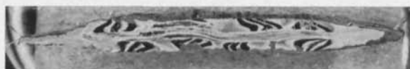
Fig. 6. Översiktsbild av det pölerade tvärsnittet av Sandegårda-svärdet, i makroetsning (Stead I). Foto (mörkfält) S. Modin. — Transverse section of the Sandegårda-sword, etched in Stead I. Photo S. Modin. 1: 1,5.
